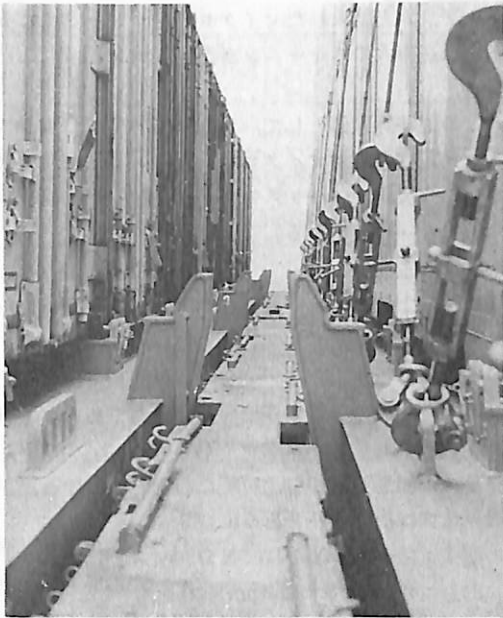
クロスデッキから見たコンテナの積載状況。ラッシングロッドは“オバQ”金物不要の特殊な形状のもの。
