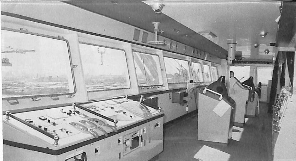
前方見透し改善のため一段と巾広型となったホイールハウス。このクラスの船としては高い6階建てのブリッジである。
