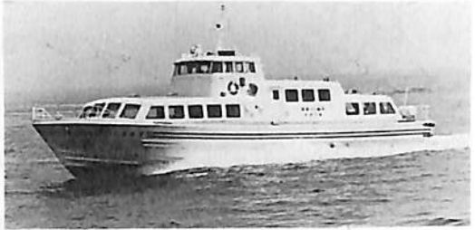
写真5・軽合金製高速旅客艇“しおかぜ”（共同汽船）/ MB820Db形×2
