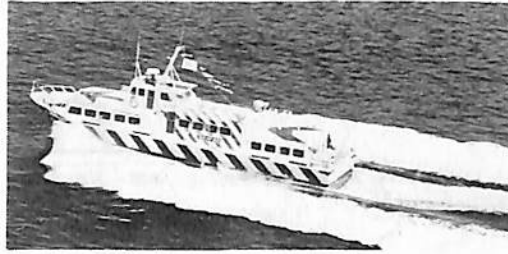
写真4・鋼製高速旅客艇“コバルトアロー1号”（伊豆箱根鉄道）/ MB820Db形×2
