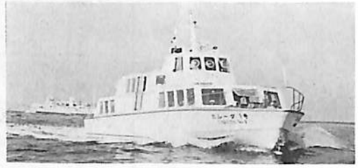
写真3・FRP高速旅客艇“ガルーダ1号”（江崎汽船）/ MB820Db 形×2
