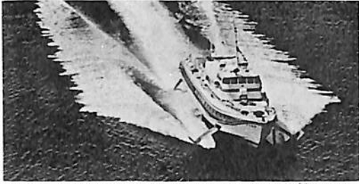
写真2・PT50型水中翼船“おおとり”（瀬戸内海汽船）/ MB820Db 形×2
