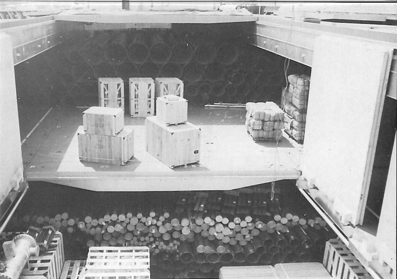
●No.2 ホールド内／ホールド内は小物プラントと鋼材、中甲板上に大口径鋼管を積載して
