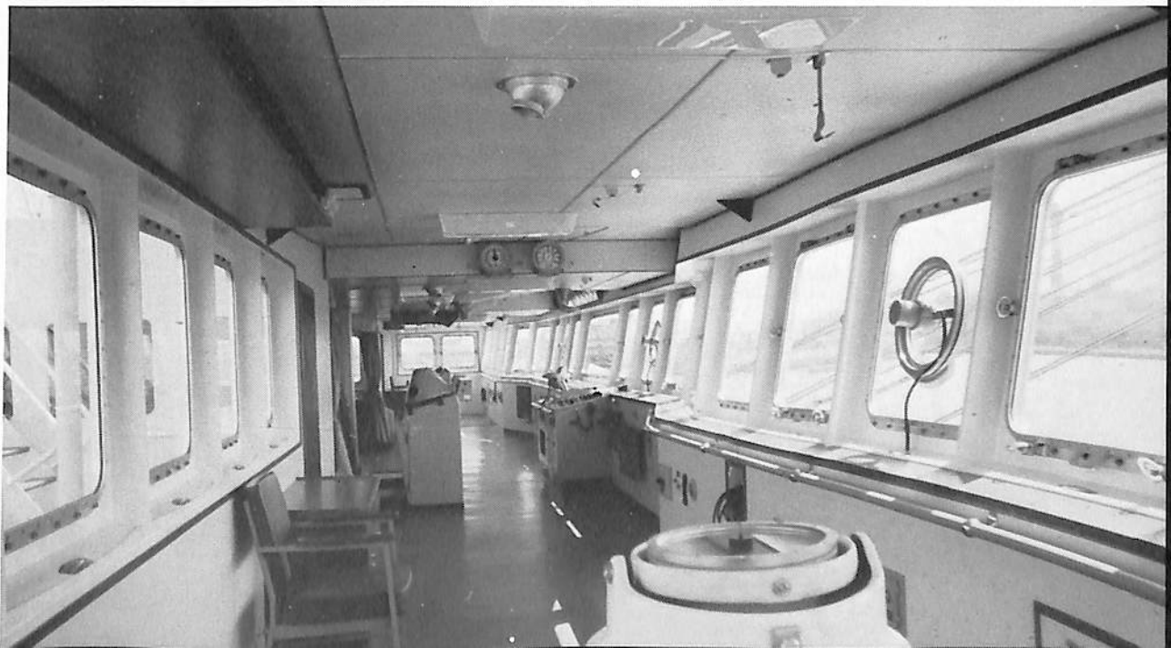
●ホイールハウス内部／ホイールハウスは太いヘビーデリックをかわして前方を見通すためウイング一杯まで拡げている。
