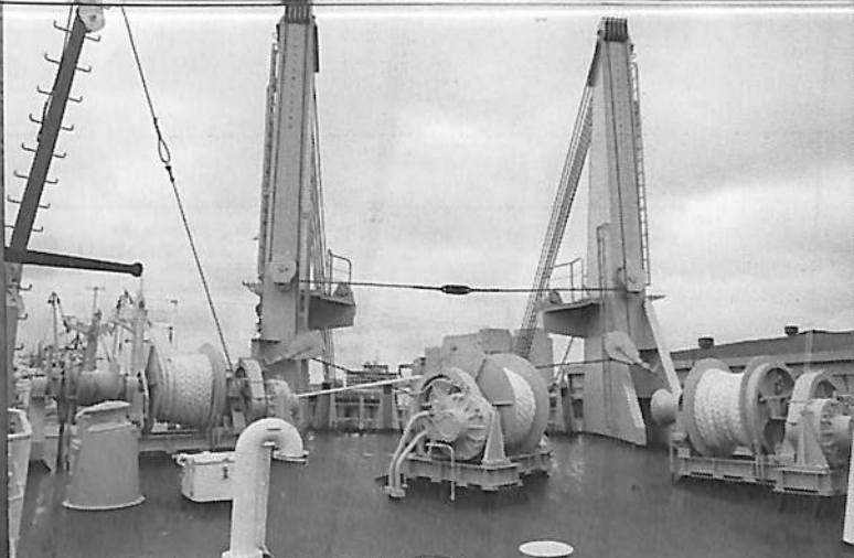
船尾楼甲板上の係船機およびランプウェイ捲上用ポスト
