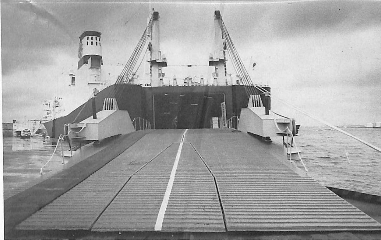
左舷船尾に設けられたアングルアジャスター付SWL40Tのランプウェイ
