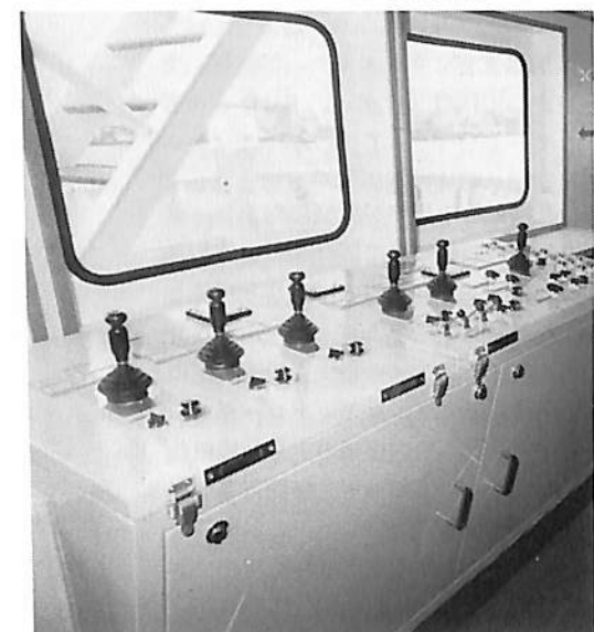
揚錨機、係船機群を集中コントロールする船橋内装備のコントロールコンソール
