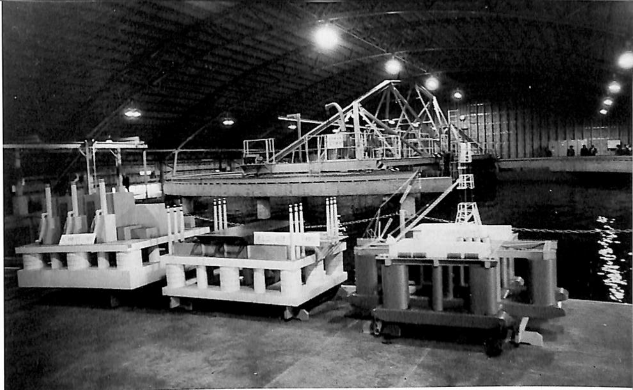
水槽でテストされる海底石油掘削船，洋上ゴミ処理プラントの模型。
