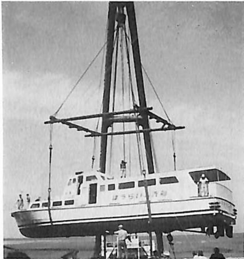
進水のため吊り上げられた“ひかり二号”の船底を見る
