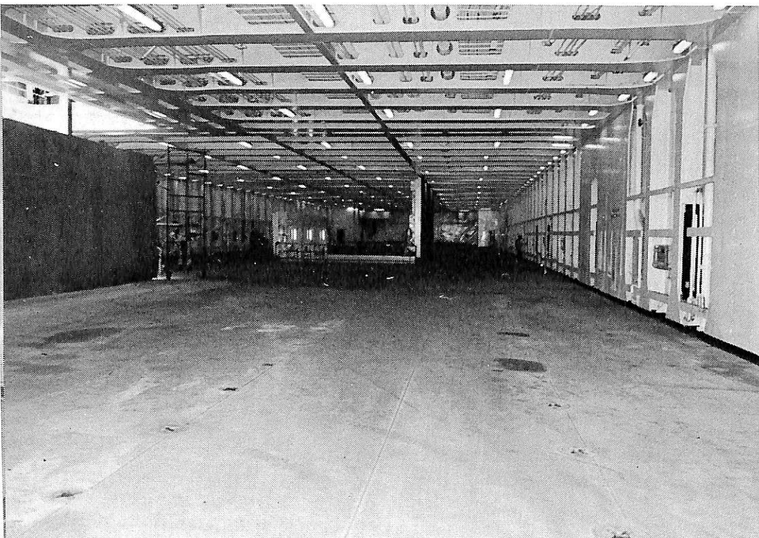
●ロワー・トレーラデッキ内。手前に70Tと奥に50Tのリフトカバーが見える
