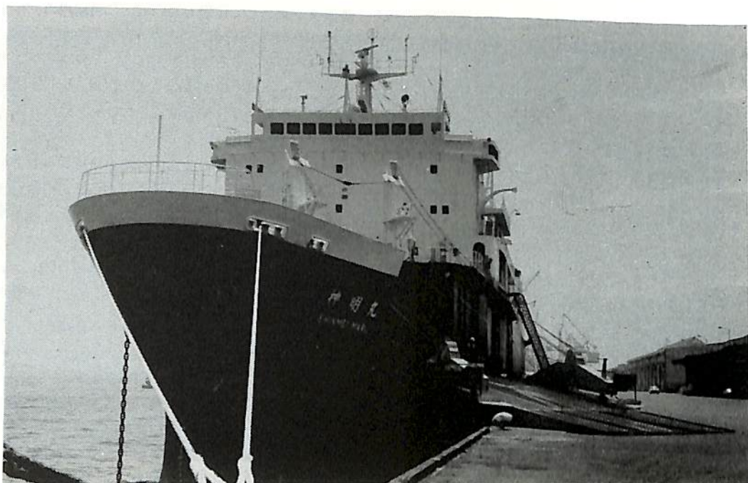
左舷船首に設けられたアングルアジャスター付SWL40Tのクォーターランプウェイおよび、パウウォータータイトドアー
