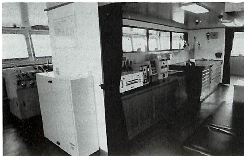
海図室内設置のドップラーログ、ロラン受信機方探、ファクシミリ等の航海計器類
