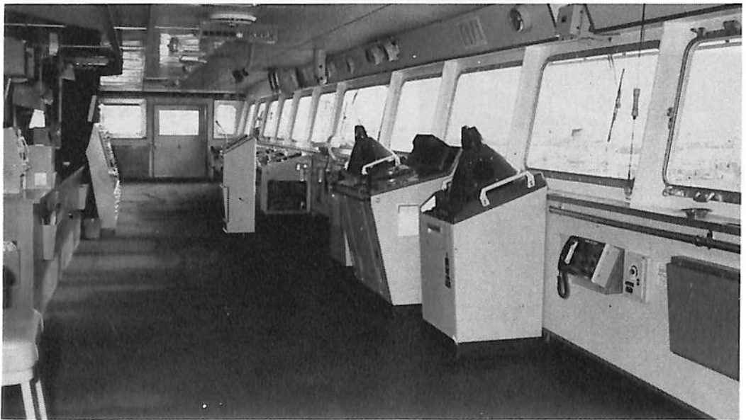
写真5・右舷より見る。2台のレーダーの中央にT O N A C (衝突防止レーダー装置)が見える。
