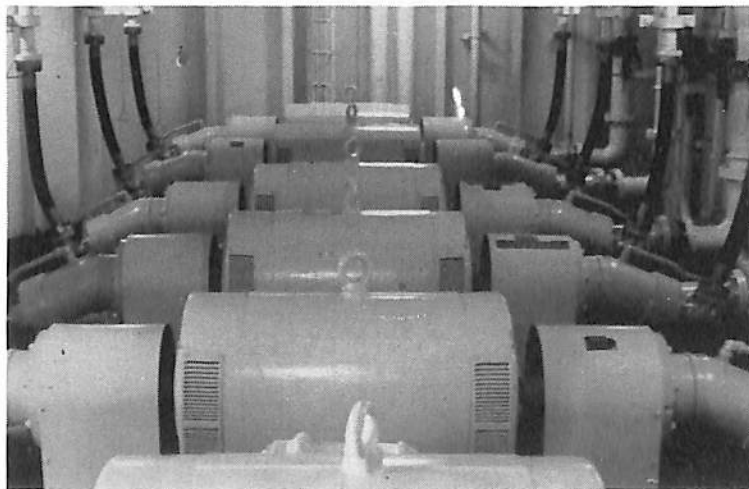
船尾部に配置されたフラモパワーパック (油圧ポンプユニット)。カーゴポンプ駆動用の作動油に 180 kg / cm 2 の高圧を与える。
