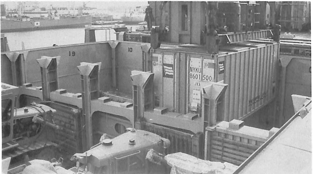
写真15・コンテナ積込中のNo.19ベイ。手前にフラットラック・コンテナ積みの重車輛が見える。
