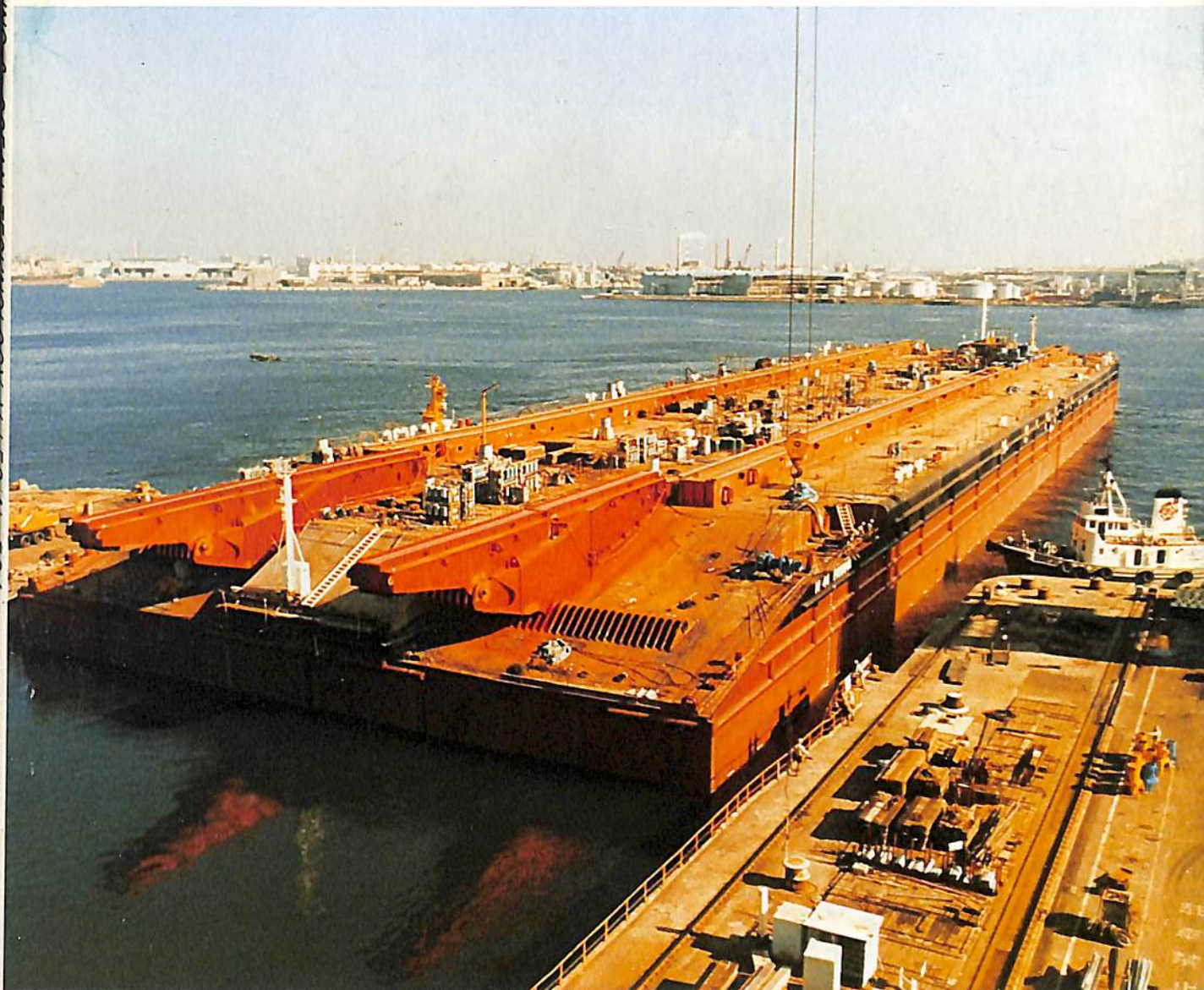
大阪工場場で建造した世界最大級のジャケット・ランチング・バージ“M44”
