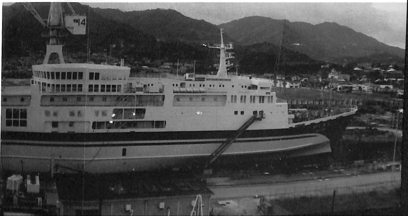
⑥接合された新船体上に車両、 船橋甲板が単独で搭載される。
