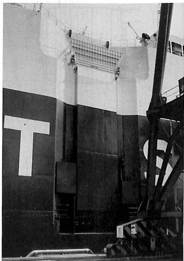
垂直型に設計された巡洋艦船尾。スターン・コーターランプは大型ヒンジアップ式で全長27m，耐荷重16トン。
