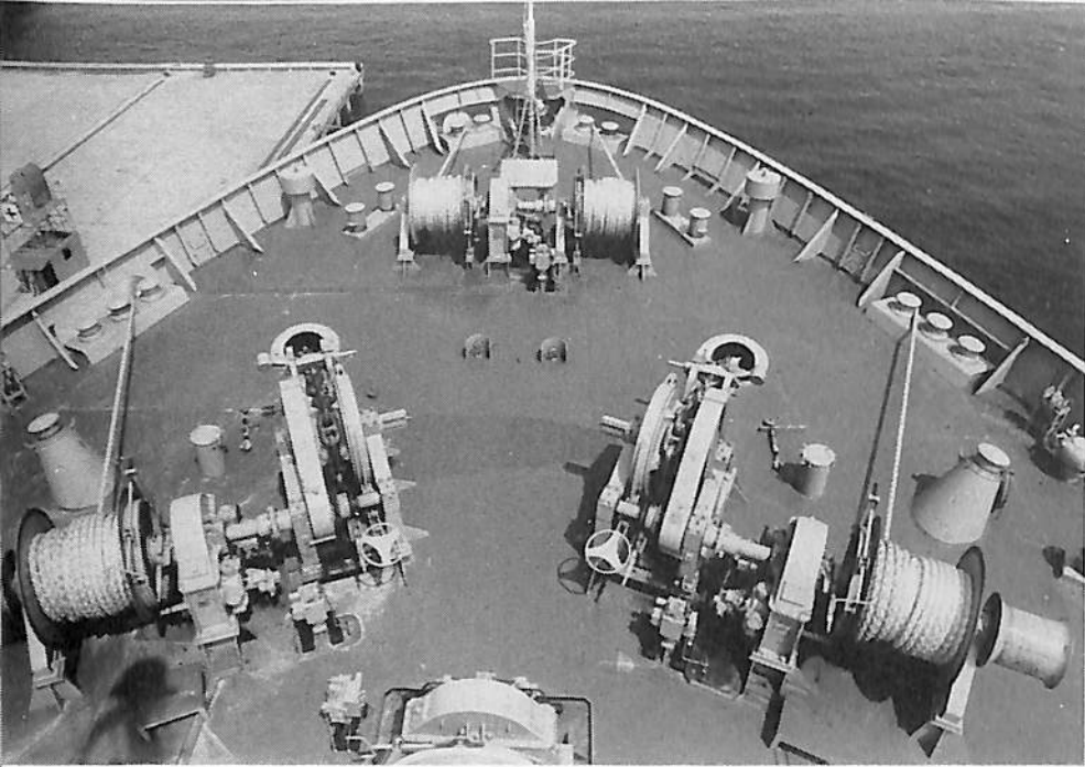
船首部の係船装置。写真中央の左右舷に係船用リモコン・レバーが見える。
