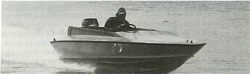
滑走型2, SN16-W。舟艇協会 1974年建造, 全長4.90m, 排水量0.6トン, 速力43ノット
