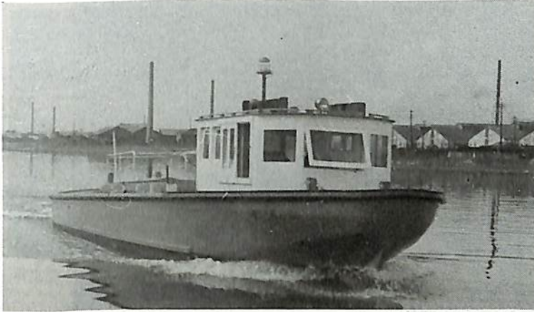
排水型14m 港内サービス艇。 南国特殊造船1951年建造，全 長14m，速力9ノット
