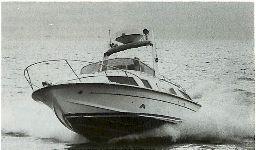
半滑走型2 “Fantom”。Failey (英) 1974年建造, 全長9.81m, 排水量5.1トン, 速力30ノット
