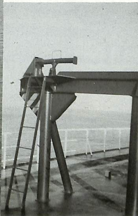
⑤この装置により舷側にハッチコーミングを かわした位置までハッチカバーの開放が可能
