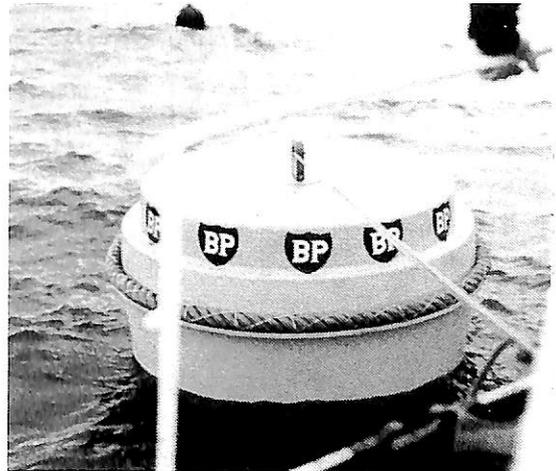
FRP製ブイ/BPによってデザインされたもの、“Cellobond”ポリエステル樹脂が使用されている。DAS島およびSolent海域で鉄製のブイに比し浮力、安定性、メンテナンスフリー等で進歩性を証明した。
