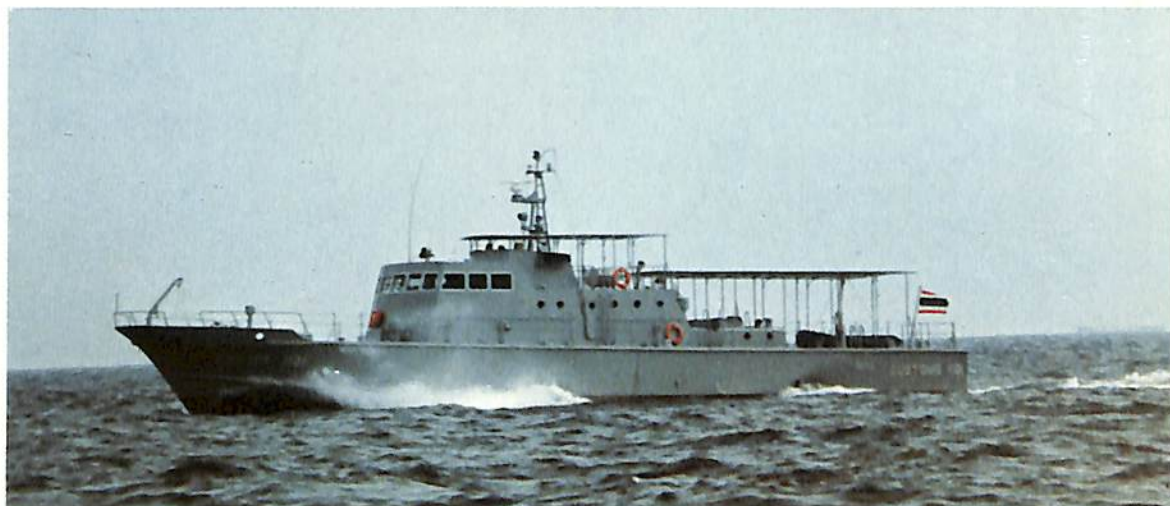
34m カスタムボート(タイ国向け) / 速度(最高)27.67ノット、主機関12V331T C82型2機、墨田川造船(株)建造
