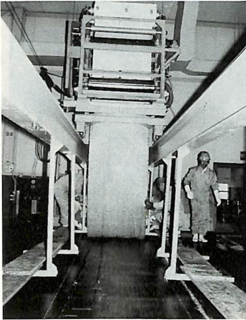
写真-3 自動含浸装置による機械積層
