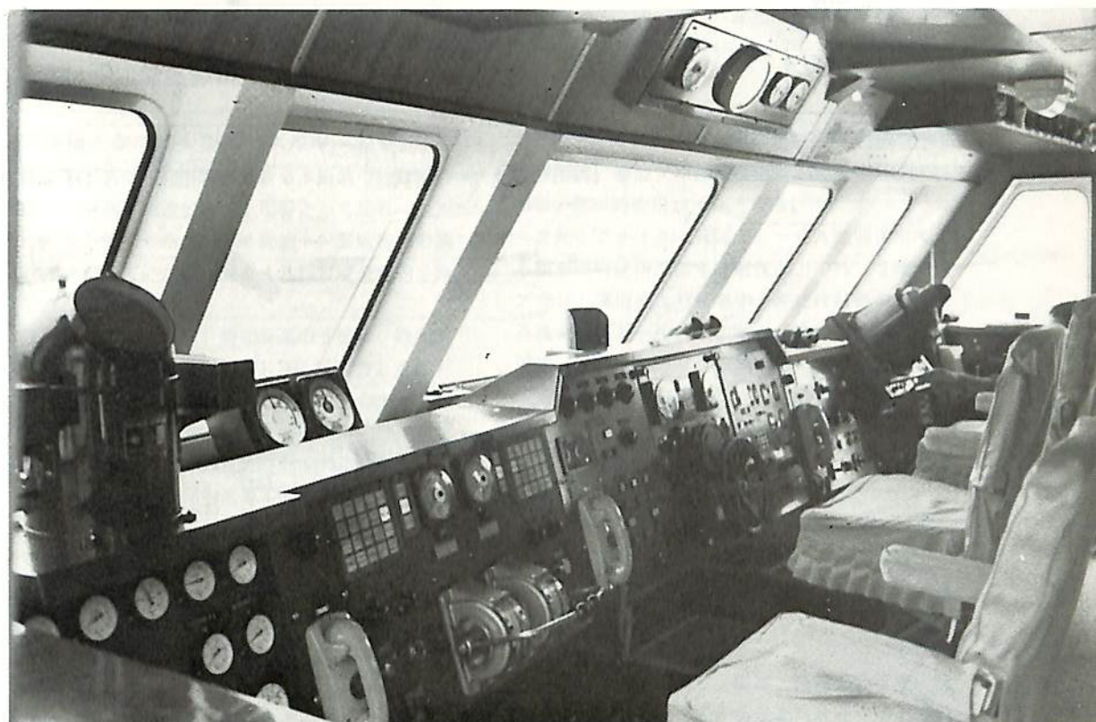
操縦席/コンピューターによるフィンスタビライザーの制御装置が装備されている
