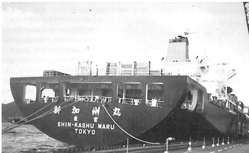
船尾にコンテナデッキを設けてある。
