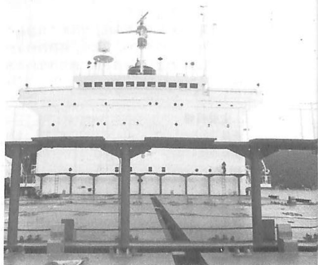
上下2段の冷凍コンテナ点検用ステージ
