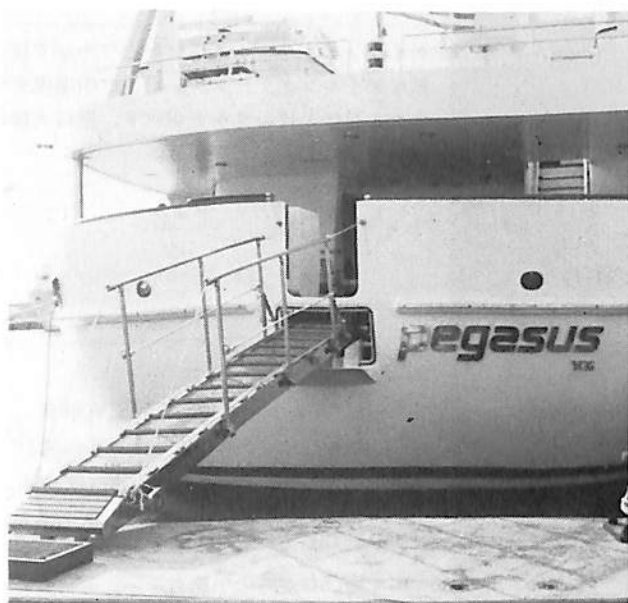
ギリシアのPiraeus 港 Flisvos マリーナに憩う“ペガサスⅣ”／油圧引込式の船尾タラップ。
