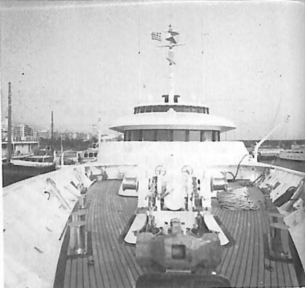
船首から見る／甲板金物，機材などにはステンレスが多用されている。
