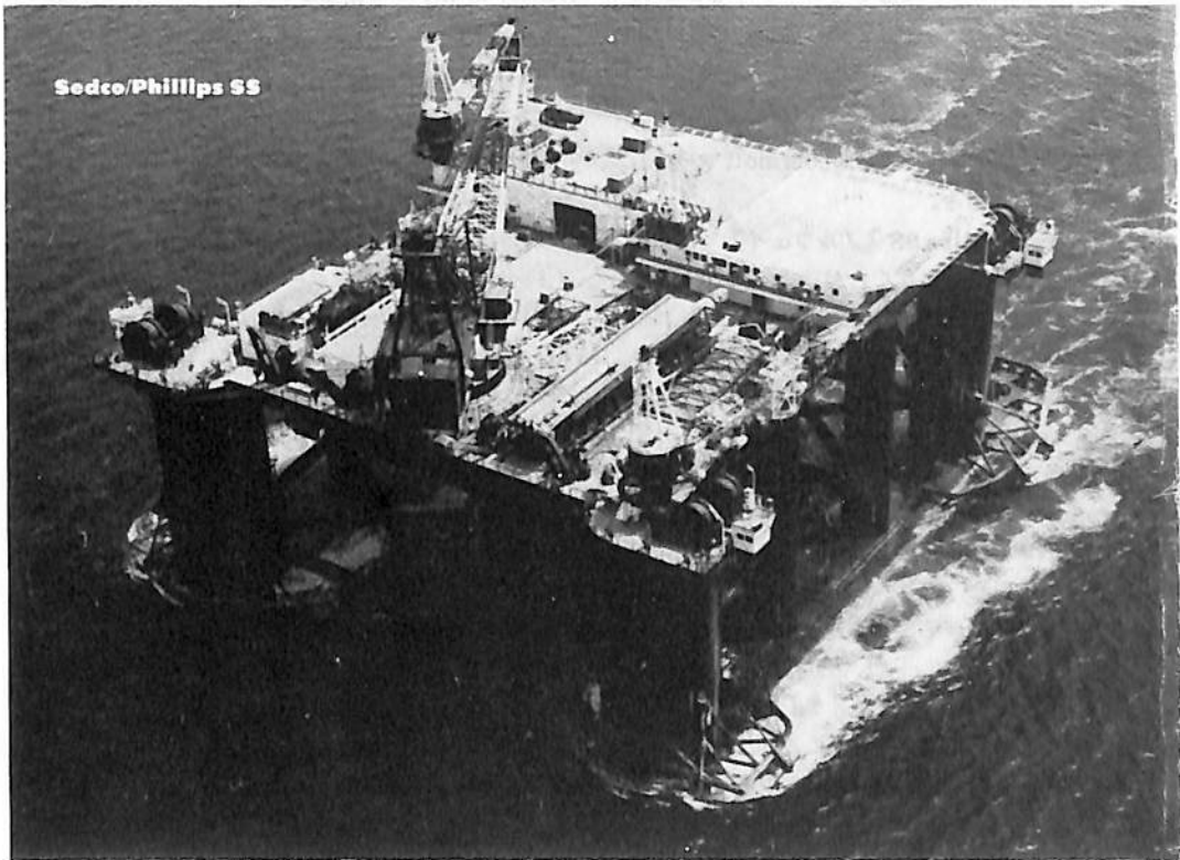
自航式半潜没型プラットフォームSedoco / Phillips SS
