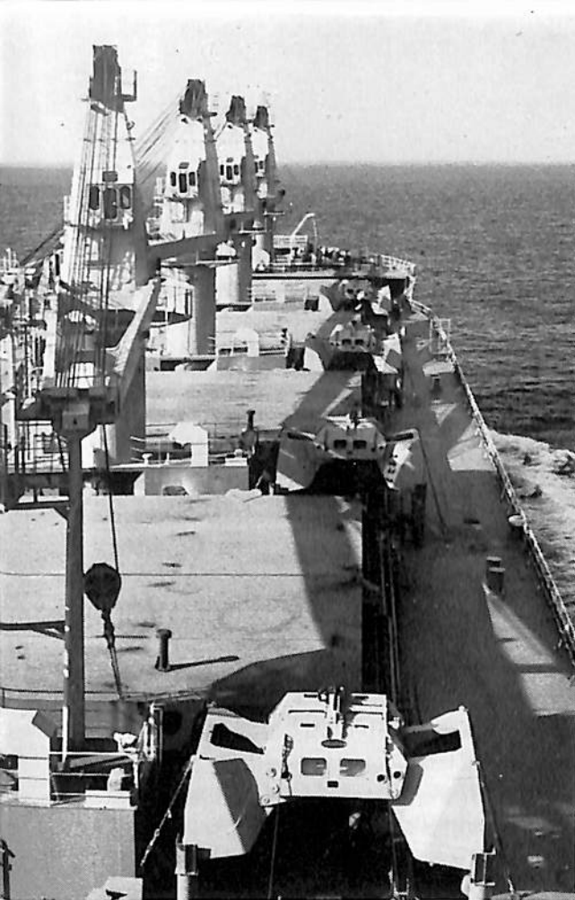
デッキクレーン5基それぞれにグラブバケットを装備
