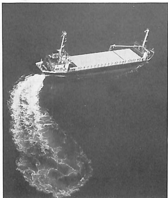
K-7かもめ式フラップ舵による旋回試験
