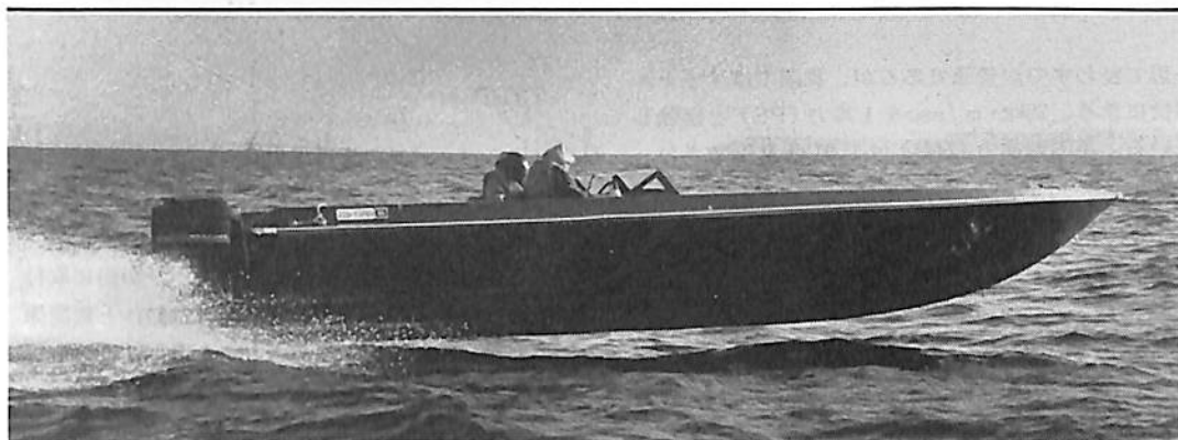
写真/カーボン繊維使用の試作艇“トレカ26”。全長7.95m, 速力50kt。舟艇協会1981年建造。
