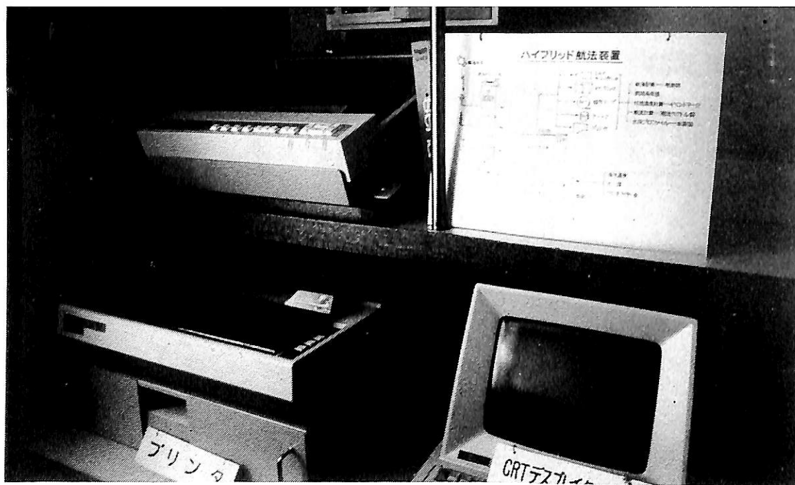
操舵室後方のナビゲーションシステムルーム内に設けられたハイブリッド航法の各装置。
