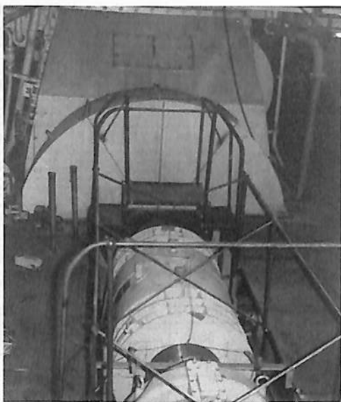
写真2. 組立完了後の検出器
