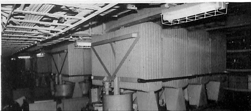
⑮ 第3甲板の第2機械室にある整流器で4基ある。“しらせ”の電気推進方式はディーゼル駆動交流発電機—整流器—直流電動機システムである。
