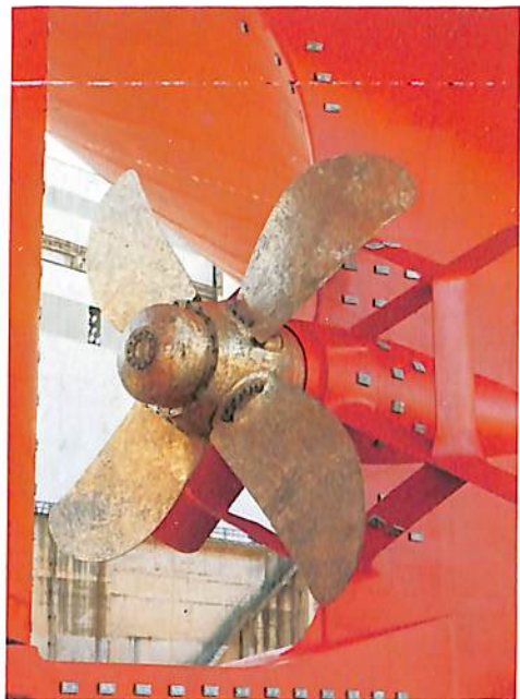
大直径可変ピッチプロペラ と三菱リアクションフィン
