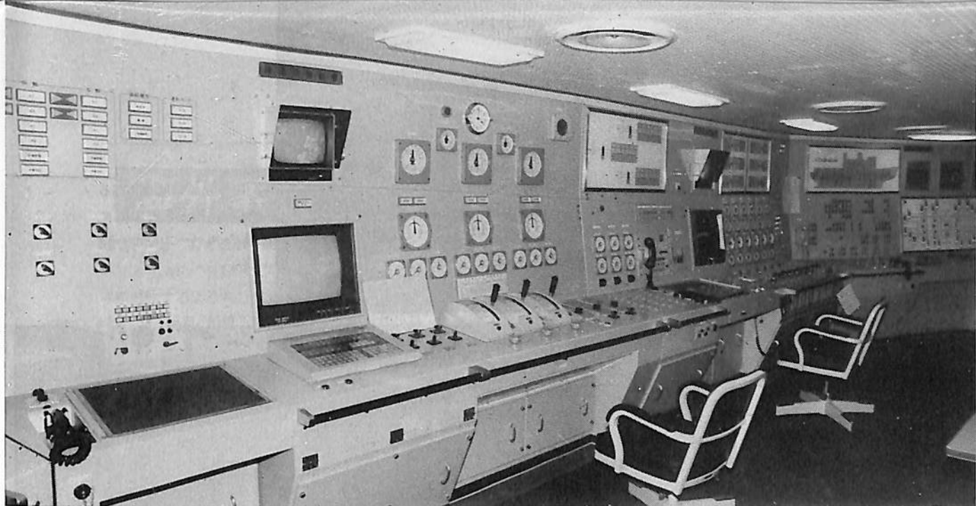
⑨最新の自動化と情報処理にコンピューターを導入，わが国の電子技術の粋が集められ，“しらせ”が自慢とする機関操縦室（第2甲板）の制御装置と計器盤。
