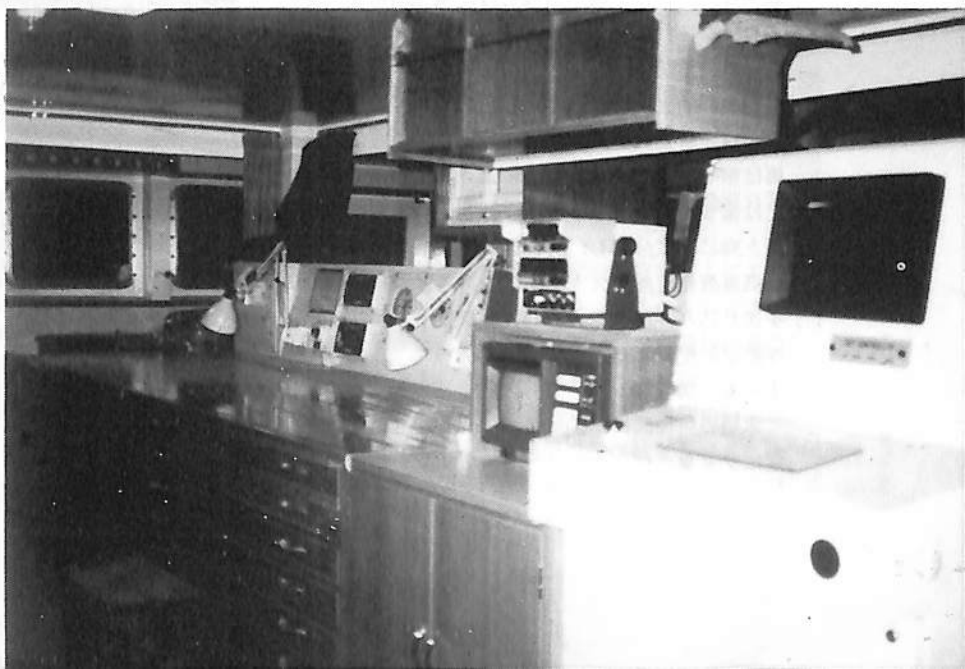
操舵室内チャート・テーブル (左), NNSS(中央), 機関部データ・ログ CRT (右)
