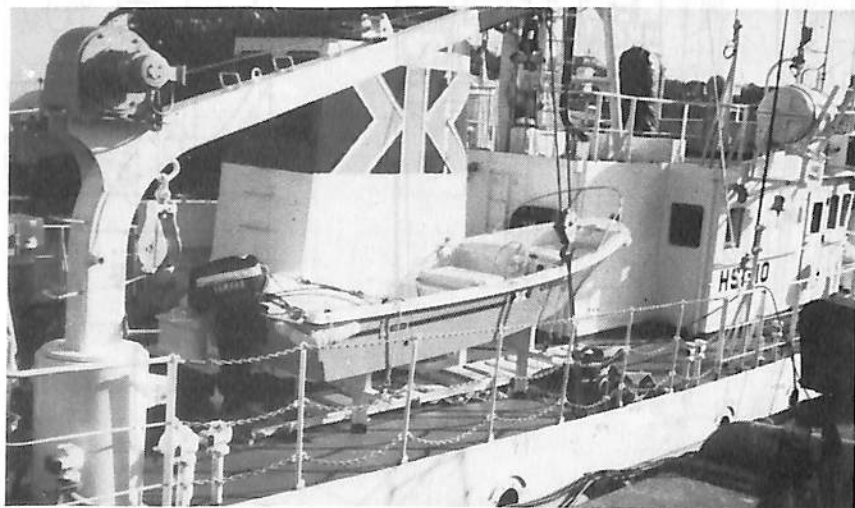
官給の特殊シーブ付生物採集ウインチとクレーン
