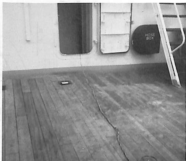
船首上甲板。船首より船尾方向を見る。上甲板全面はすべて木甲板張りである。
