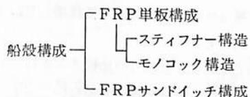
上表に示すように、FRPによって船殻外板、甲板を構成する場合、大きく分けると二通りある。
