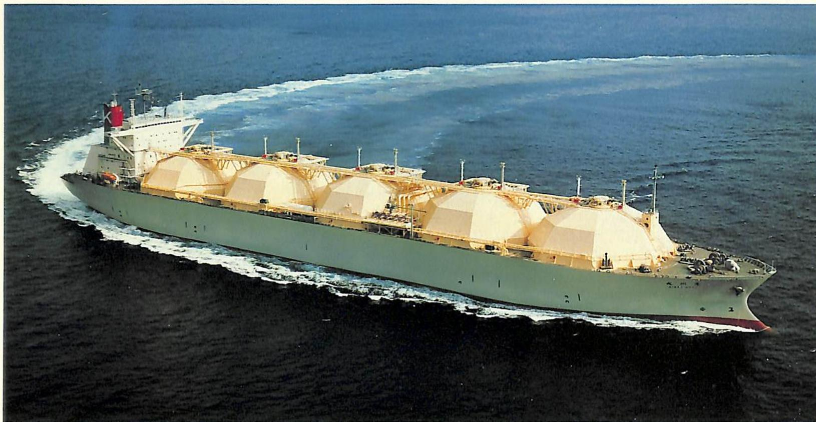
▲125,000<sup>m</sup>型川崎—モス方式のLNG船“尾州丸”は、当社が建造した国内船第一船で、インドネシアバダック増量プロジェクトに就航します。
