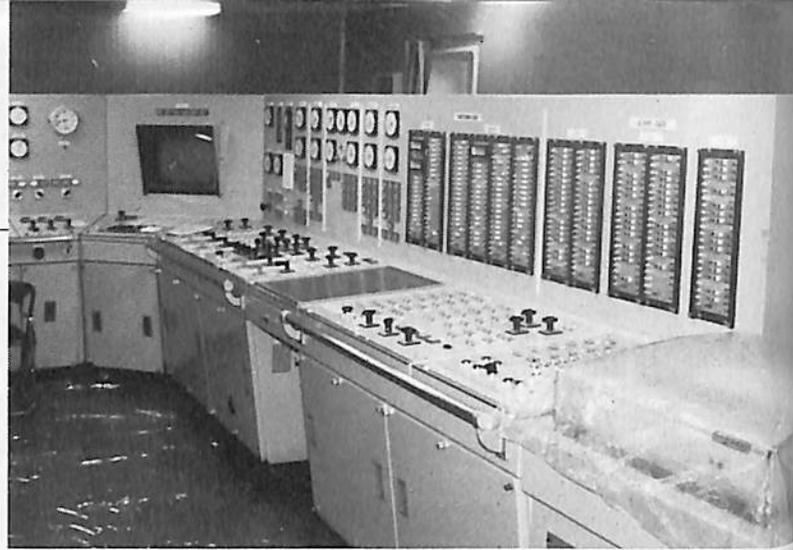
長、大口径弁の動力化、予備品コード化による予備品管理システムの採用、主要機器の自動逆洗化、主機低負荷時の排ガス・ボイラーへの煤附着防止のため、自動バイパス・ラインの設置及びスートブローの遠隔制御、ターボ発電機発停作業の簡素化等、18名マイナス・アルファによる少人数運航に対し、充分配慮するとともに、計画整備方式による整備体制の充実化を図った。
