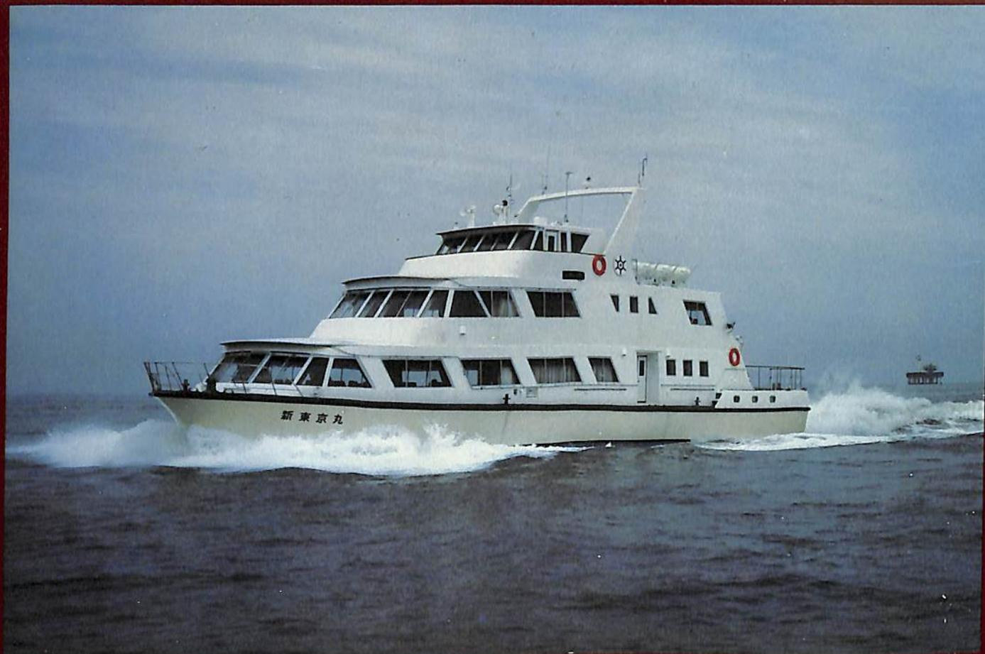
V型チャイン船型 上甲板、遊歩甲板、船橋甲板の三層甲板構造である。
