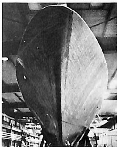
進水前のFRPサンドイッチ構造船殻
