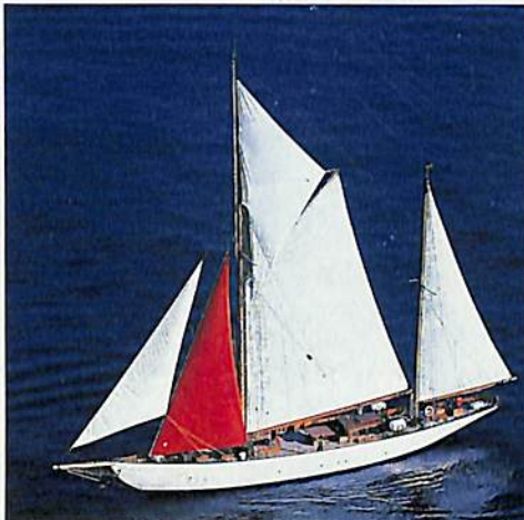
〔上左〕シナーラ(日本/ケッチ・73t, 全長29.26m, 幅5.70m, 帆面積319㎡・1927年建造)(写真:西武流通グループ)
