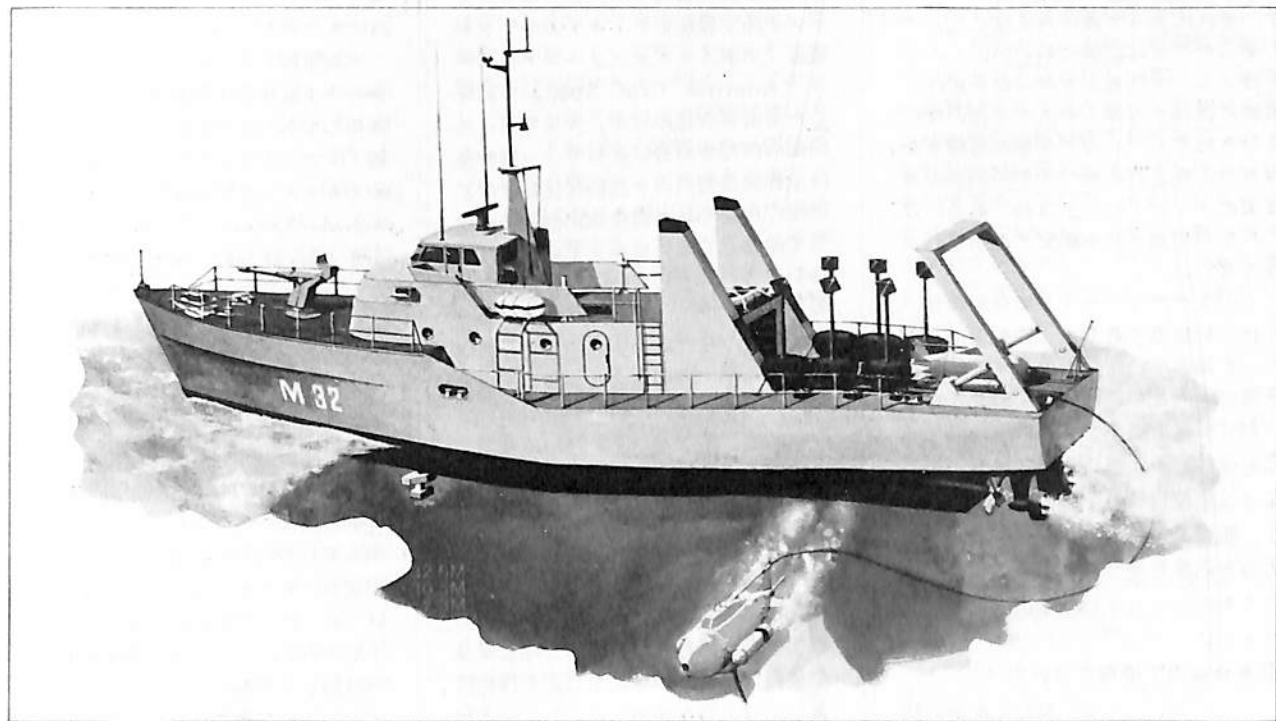
FRPサンドイッチ構造による掃海艇 Hymarine。主要目・全長32.6m、水線長30.5m、幅7.3m、吃水1.98m、排水量150t
