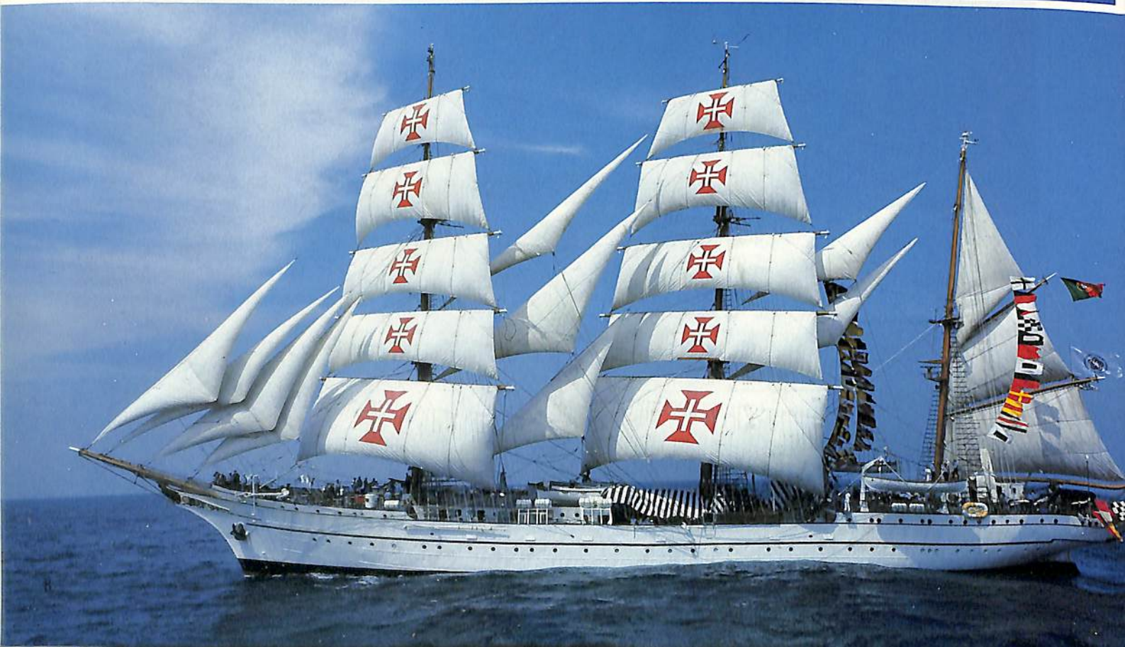
〔下〕サグレス(ポルトガル/パーク・I, 516t, 全長89.5m, 幅12m, 帆面積1,935㎡・1937年建造)
