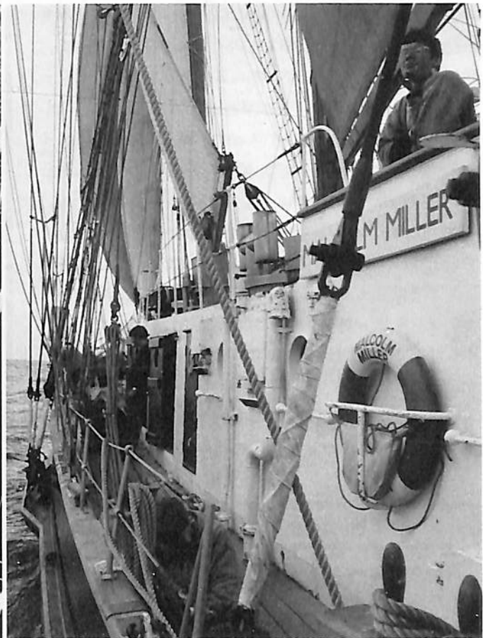
↑ブリッジの左舷側。フォア・マストのブームのわきに見えるのが (写真中央)、メイン・エンジンの煙突。
