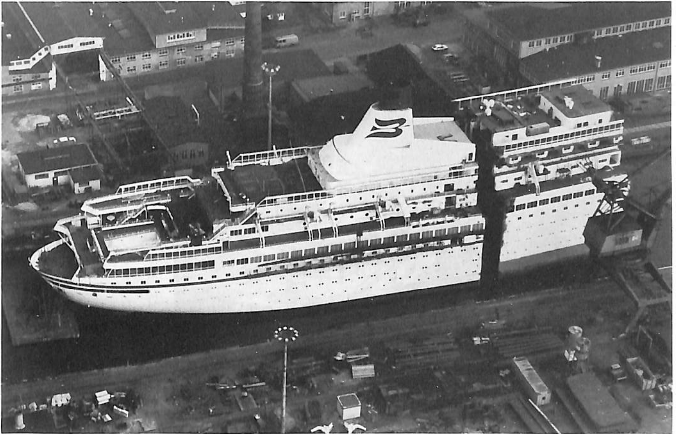
増加部分（ミッドセクション）が、船尾部に接近している模様。船尾部にも安定用のポンツーンが取付けられている。機関部等を内蔵する船尾部は、新増加部で一段と重いことが写真でわかる。
