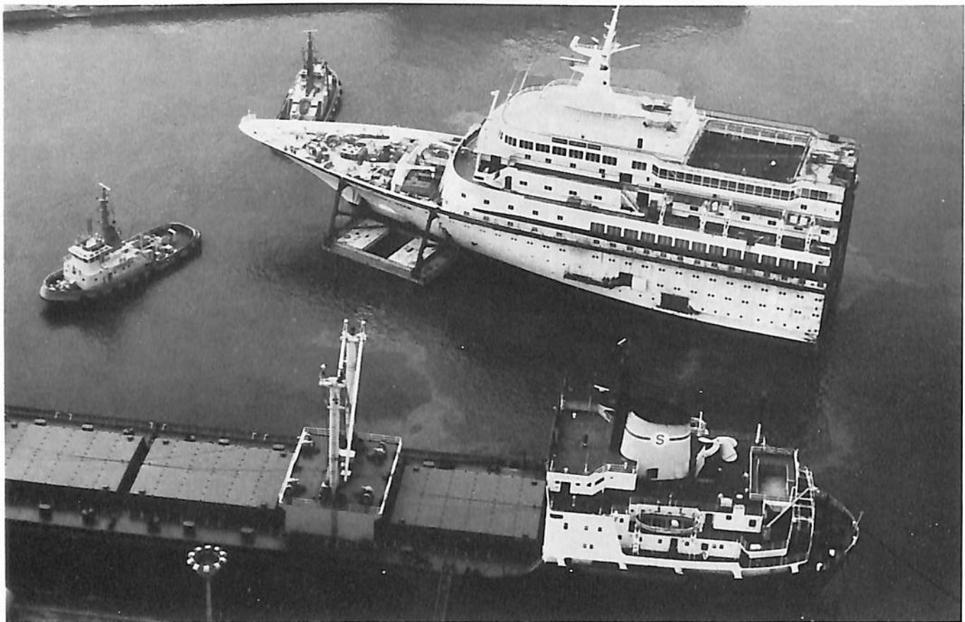
ドックから一時引き出された船首部分。この部分には船体安定のため、両サイドにポンツーンが取り付けられている。さらに、船内には、バラスト用に約160トンの水が張られている。
