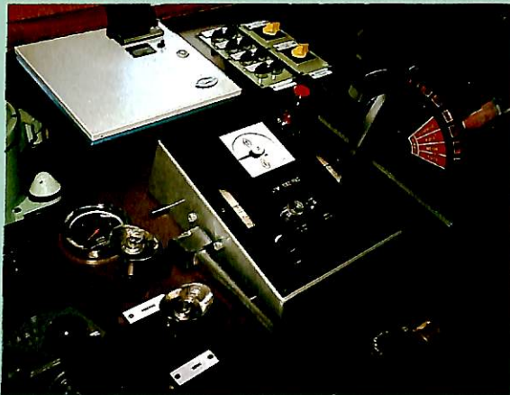
右・威風堂々のクオウテモックのファンネル。 左下・クオウテモックの船長公室。 左上・ブリッジにある操作車（クオウテモック）。 中央にあるのが可変ピッチプロペラのレバー。 隣のボイス・チューブとの対比がおもしろい。
