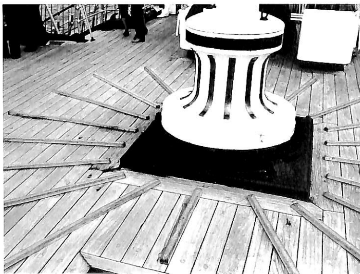
キャプスタンの周りのスベリ止め。この上を回ってロープを巻き取る。(サグレス)
