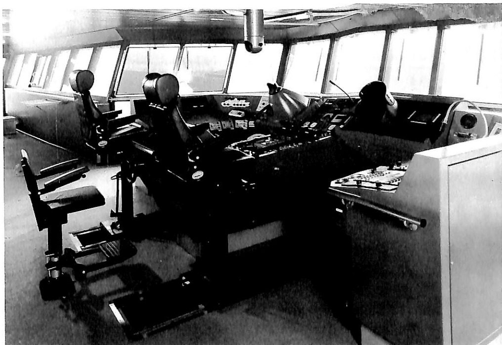
▲船橋(ブリッジ)。全景外観からもわかるように操機部分が張り出した構造になっている。操機手および当直士官はイスに掛け、そのままワッチに当たれるようになっており、士官用のイスは前後に移動が容易である。
