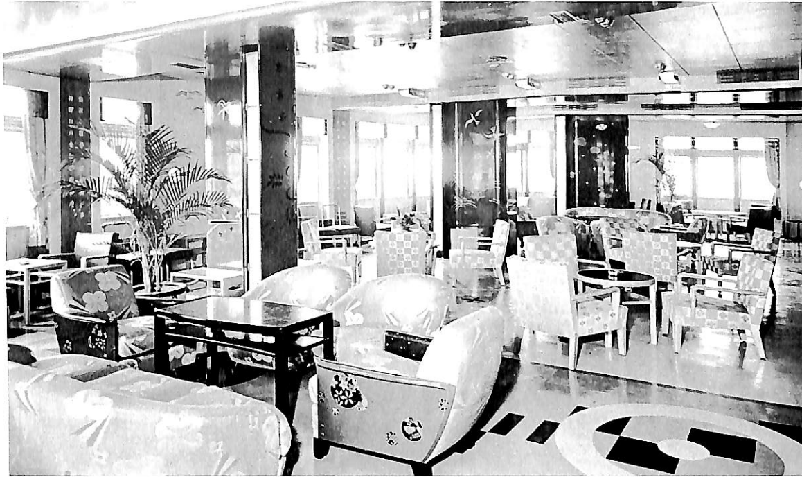
〔1等喫煙室〕プロムナード・デッキ最前部にあり、周りの角窓は上下フルサイズになっている。また、室内からの眺望を良くするため、外部のブルワークは低めにするなど細かい配慮が払われている。このデッキの最後部にはレストラン、中央部に図書室、バー、ギャラリーが配置されていた。
