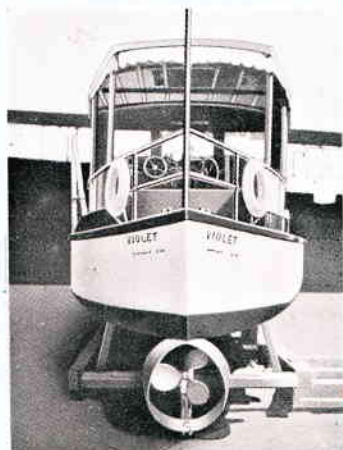
(上) セメント機械用 (中) 北海道帝國大學 (下) キツチマンスラダー コンバインド 練習船 おしよる丸 (左) 開 舵 (全速前進) チューブミル (右) 閉 舵 (全速後進)
