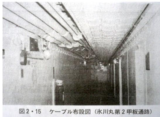
図2・15 ケーブル布設図（氷川丸第2甲板通路）
