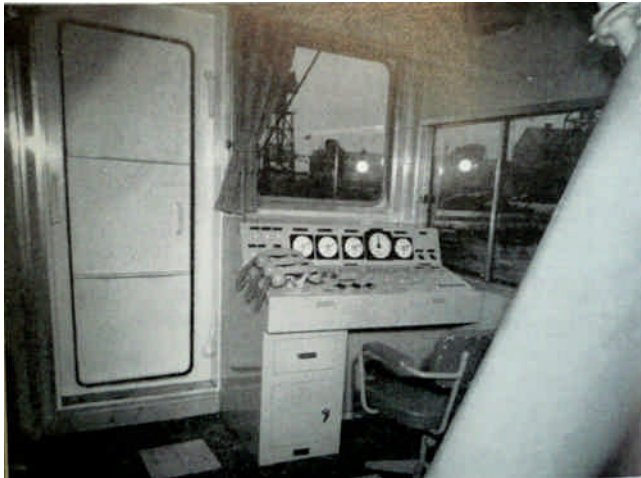
10) W36-01 「讃岐丸」ポンプ操縦室 (トリム、ヒール調整)
