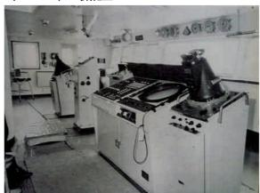
右写真は機関制御盤で、メータ、ランプ、スイッチなど多数見える。まだ MIMIC は採用されていない。
