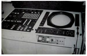
上の写真は 衝突予防装置の表示部である。 右の写真はNNSSの受信処理装置で入出力タイプライターが見 える。計算された測位位置はこのタイプライターで出力される。
