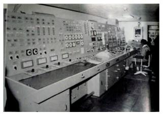
右の写真は荷役制御盤で、垂直面に各タンクの メータ類、水平面に各タンクのバルブのスイッチ やランプがある。また配管系統が見える。
