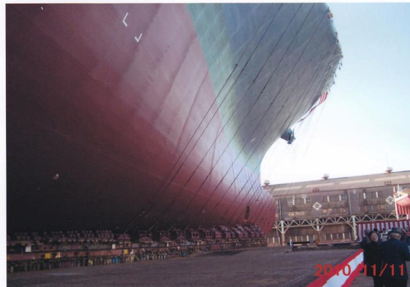
三菱神戸建造の最後のコンテナ船のFORE POPPET. 大きな構造物を何本ものワイヤで船体に吊っている
