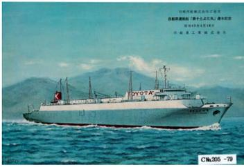
引き続き多くの新造・改造の自動車兼ばら積船が就航したが、復航のばら積貨物の集荷日程が変わることがあって配船スケジュールに不安定なところがある。9層の自動車甲板に乗用車 2,082 台を搭載するわが国最初の**外航自動車専用船**第十とよた丸が 1970 年に川崎神戸で進水した。
