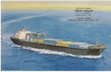
1960年代に鉱石・石炭・穀物などのばら積貨物が急増し始めると、それらの積み付けが容易な船型が開発され、デッキクレーンなどの荷役設備を完備して多目的貨物船と同じ貨物を扱う 50,000 重量トン以下の**多目的ばら積船**、港の岸壁荷役装置に頼り荷役装置を持たないより大型の**汎用ばら積貨物船**、鉱石専用の**鉱石運搬船**、石炭専用の**石炭運搬船**などの専用船が生まれた。後の三者は世界経済の拡大に伴い 1970 年頃より急速に大型化が進み、現在では 20 万重量トンを超
