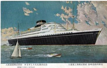
左図は 1938 年に三菱長崎で進水した大阪商船の世界一周航路客船 12,755 総トンあるぜんちな丸である。本船は資材の全てが国内産で調達され、主機関は三菱長崎開発のディーゼル機関 2 基搭載である。有名な和辻春樹博士の指導で梁矢・舷弧が廃止され外観も細部まで検討され、船内装飾は中村順平、村野藤吾など著名な国内の建築家により高度の日本調が追究されて、わが国で一番美しい船と云われている。
