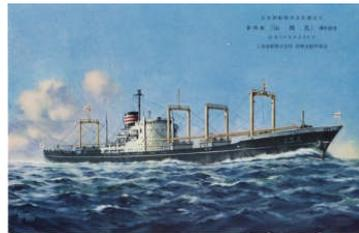
戦後、これらの航路が再開されるとスピード競争が繰り広げられた。左図は 1953 年に三井玉野で進水した 10,200 重量トン三井船舶榛名山丸である。当時の高速貨物船は通常ディーゼル機関 2 基搭載であったのを排気タービン過給により機関出力を増大させ 1 基搭載にして推進効率を良くし、1954 年に横浜～サンフランシスコ間を 9 日 17 時間 27 分、平均速力 19.33 ノットで走破して太平洋ブルーリボンを獲得した。右図は 1963 年に三菱長崎で進水した 12,800 重量トン日本郵船山城丸で、多くの水槽試験と造波抵抗理論により新しい船型を開発して、直前に建造された同社の同じ重量トン、同じ船速の高速貨物船の主機馬力 17,500 馬力から 4,500 馬力も少なくすることに成功した。これらにより海外名門船会社から多くの高速貨物船の注文が相次ぐと共に、国内の高速貨物船もさらに高速化し試運転速力が 23 から 24 ノットへと高速化した。
